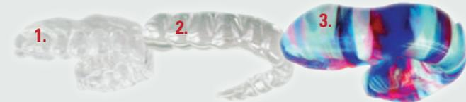
esempio Playsafe heavy-pro: **1.** Base, flessibile (2,0 mm) **2.** strato di rinforzo, duro (0,8 mm) **3.** Strato di copertura, flessibile (4,0 mm)
