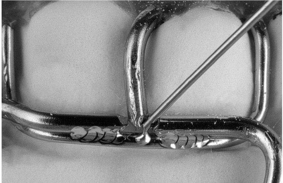
Se lo spazio tra gli elementi non può essere ridotto ai minimi termini, è possibile utilizzare come riempitivo l'apposito filo per saldatura al laser da  $\varnothing$  0,35mm No.ord. 528-210-00 se l'apparecchio viene costruito in remaloy® oppure con filo ortodontico da  $\varnothing$  0,35mm No.ord. 535-035-00 se l'apparecchio viene costruito in filo remanium®.
